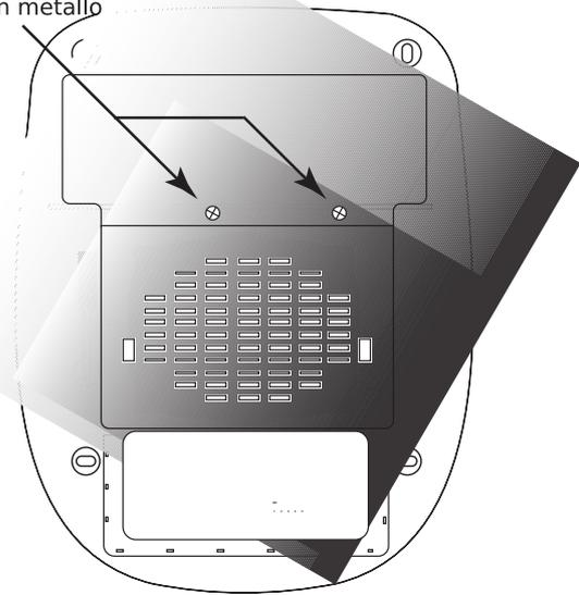
2. Collegare la batteria e rimontare la protezione in metallo.
